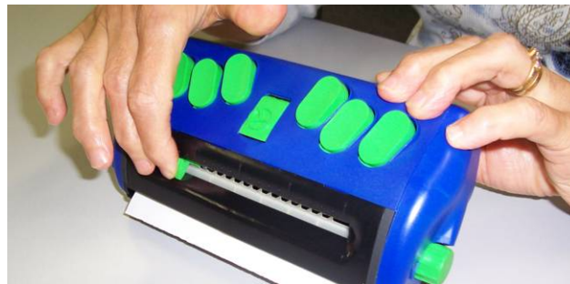
Návrat ukazatele do levé krajní polohy (návrat vozu)
